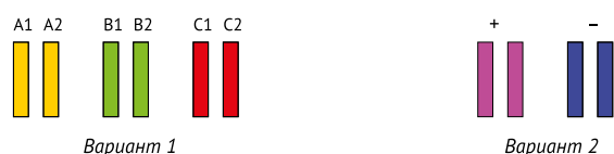
Рис. 4. Шинопроводы с расщепленными фазами.
