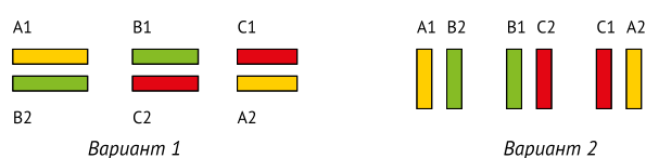
Рис. 5. Схемы шинопроводов со спаренными фазами.
