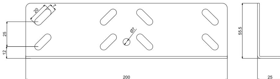
В одном соединительном элементе Н=75-100 следует использовать 8 болта М6х12 и 8 гаек М6
