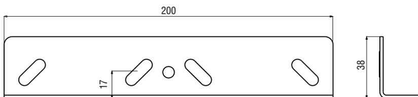
В одном соединительном элементе Н=60 следует использовать 4 болта М6х12 и 4 гаек М6
