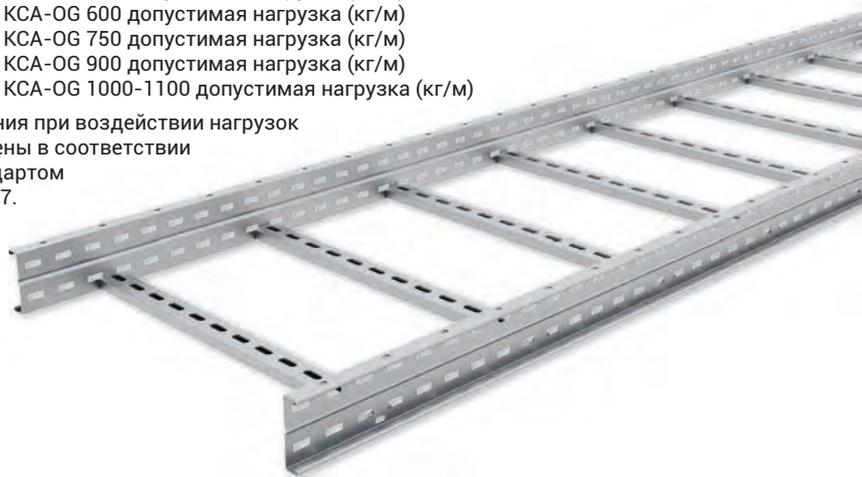
"Расстояние между опорами кабельных лестниц не должно превышать длины кабельной лестницы. Так, для кабельной лестницы OG длиной L=3 м опоры устанавливаются с интервалом 3 м или менее".
