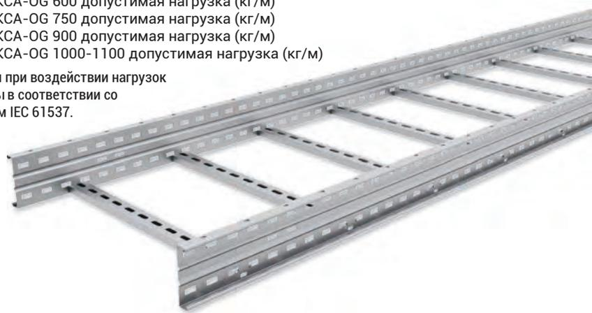
"Расстояние между опорами кабельных лестниц не должно превышать длины кабельной лестницы. Так, для кабельной лестницы OG длиной L=3 м опоры устанавливаются с интервалом 3 м или менее".
