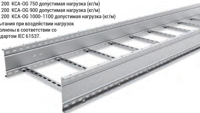
"Расстояние между опорами кабельных лестниц не должно превышать длины кабельной лестницы. Так, для кабельной лестницы OG длиной L=3 м опоры устанавливаются с интервалом 3 м или менее".
