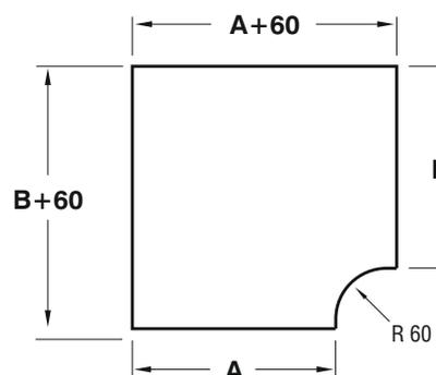
**►► КРЫШКА ГОРИЗОНТАЛЬНОГО Т-ОБРАЗНОГО ОТВЕТВИТЕЛЯ УКК R=60**
